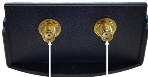
Connecteur antenne 3G/GPRS    Connecteur antenne GPS (option)
